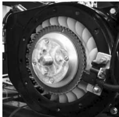
Abbildung B.1: 60-2 Geberrad und Hallsensor zur Drehzahlerfassung
