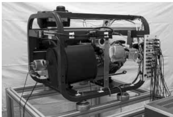
Abbildung 6.19: Teststand auf Grundlage des Notstromaggregates ESE 2000 BS der Fa. ENDRESS
