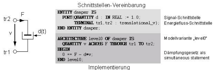
Bild 6: VHDL-AMS-Modell eines mechanischen Dämpfers
