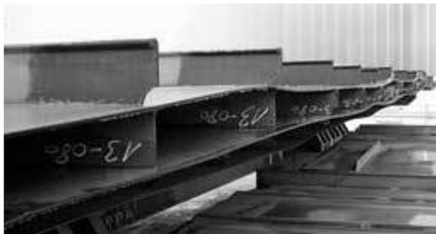
**Bild 1:** Verzug einer komplexen Schweißverbindung [1].
