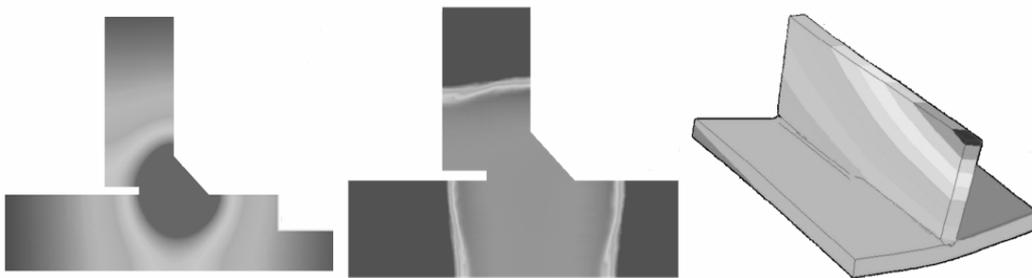
**Bild 3:** Temperaturfeld (links), Martensitverteilung (mitte) und Verzug (rechts).
