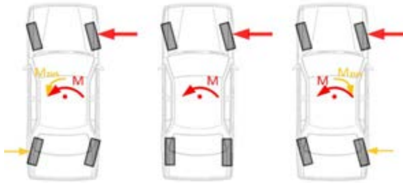
Abbildung 3: Radeinschlag bei der Hinterradlenkung bei pos. Vorderradlenkwinkel [2]
